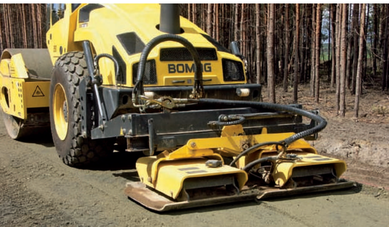
Отличное качество поверхности: BW 213 DH-4 с навесными плитами.
