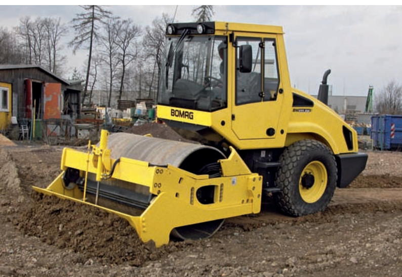
Планировка и уплотнение грунта одновременно: дорожный каток с отвалом, здесь представлена модель BW 177 DH-4.
