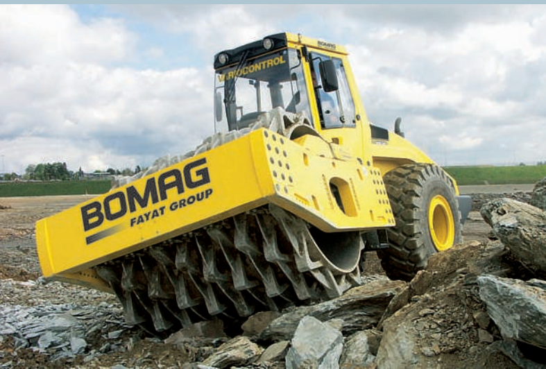
Горная порода мягкой и средней степени твердости – работа для скалоломного банджа
