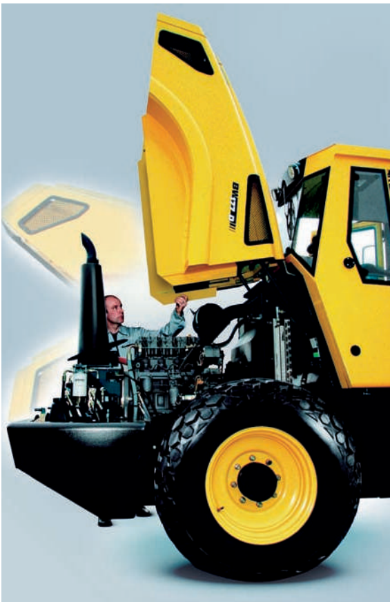
Безопасность: небольшое количество мест, требующих техобслуживания, доступ к ним возможен с земли. Капот легко открывается вручную.
