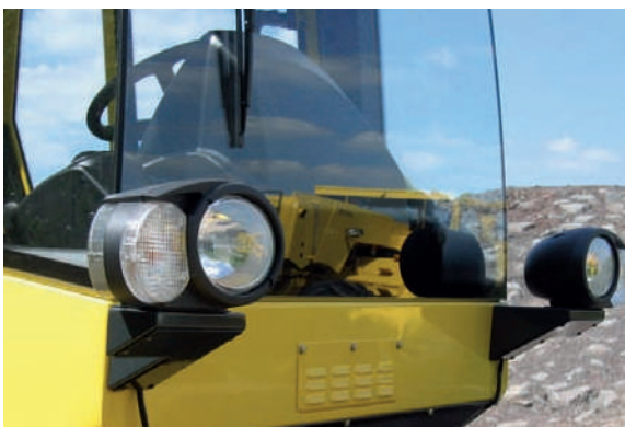
Освещение согласно «Техническим требованиям к эксплуатации безрельсового транспорта» для безопасной работы на дороге.
