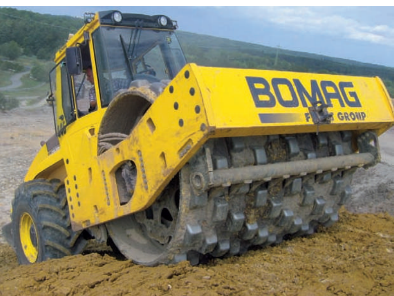
Привод серии DH – способность к преодолению подъемов до 63 %. На фото изображен грунтовой каток BW 219 PDH-4 при строительстве дамбы.
