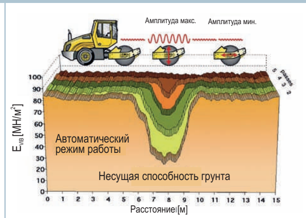
... и равномерное уплотнение при минимальном количестве проходов.
