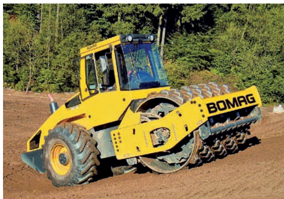
Мощность и гибкость в работе на полигонах бытовых отходов: модель BW 213 DH с трамбовочной поверхностью катка и тракторными шинами
