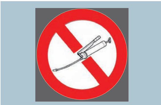
Отсутствие смазочного ниппеля: меньше техобслуживания, дольше срок службы.
