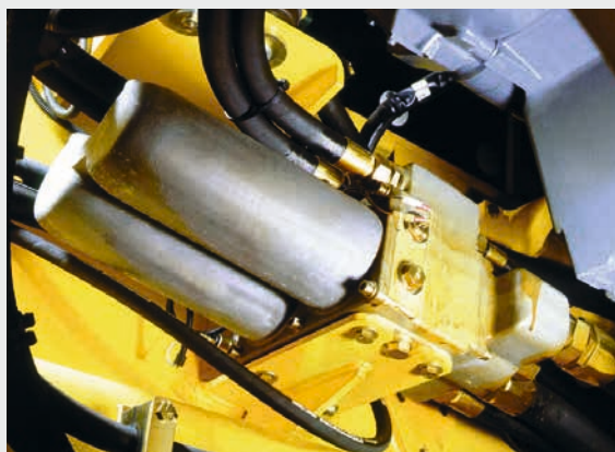
Система фильтров очистки противотоком гидравлики с электронной системой контроля.
