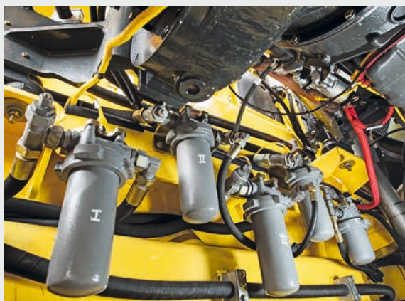
Система фильтров гидравлики.
