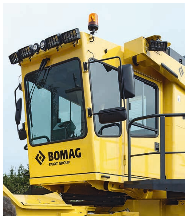
Комфортная кабина, соответствующая стандартам ROPS и FOPS.
