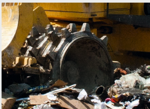
Скребки очищают колеса, что гарантирует высокую степень уплотнения.
