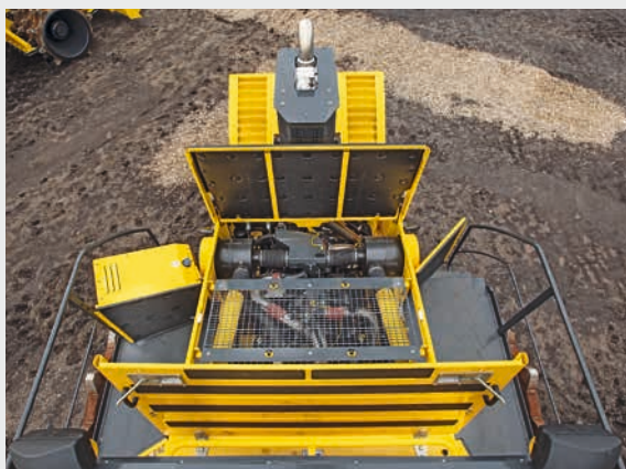
Быстрый доступ ко всем местам технического обслуживания.
