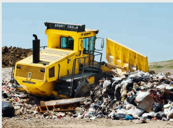
Оптимальное уплотнение достигается благодаря эффекту качающегося сочленения, которое обеспечивает равномерное распределение нагрузки между колесами уплотнителя.
