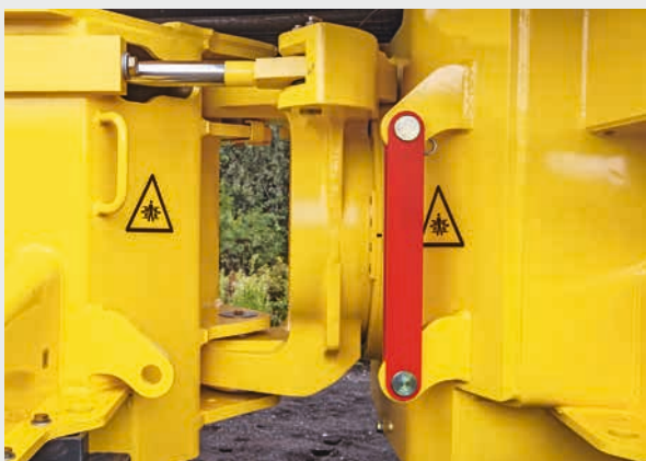
Оптимальное сцепление: качающееся шарнирное сочленение обеспечивает постоянный контакт с землей.
