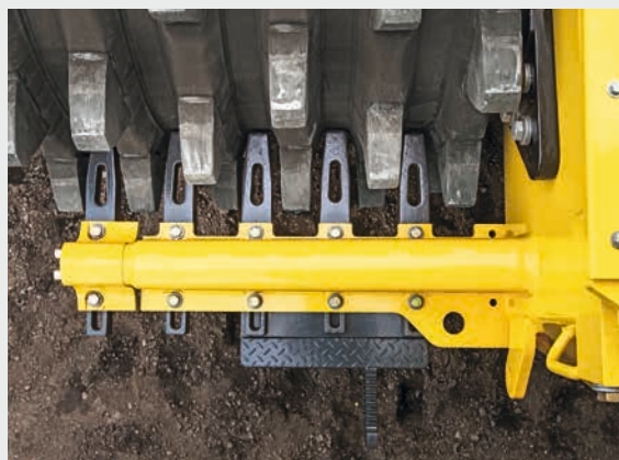
Чистые колеса со скребками двойного действия для оптимального уплотнения.
